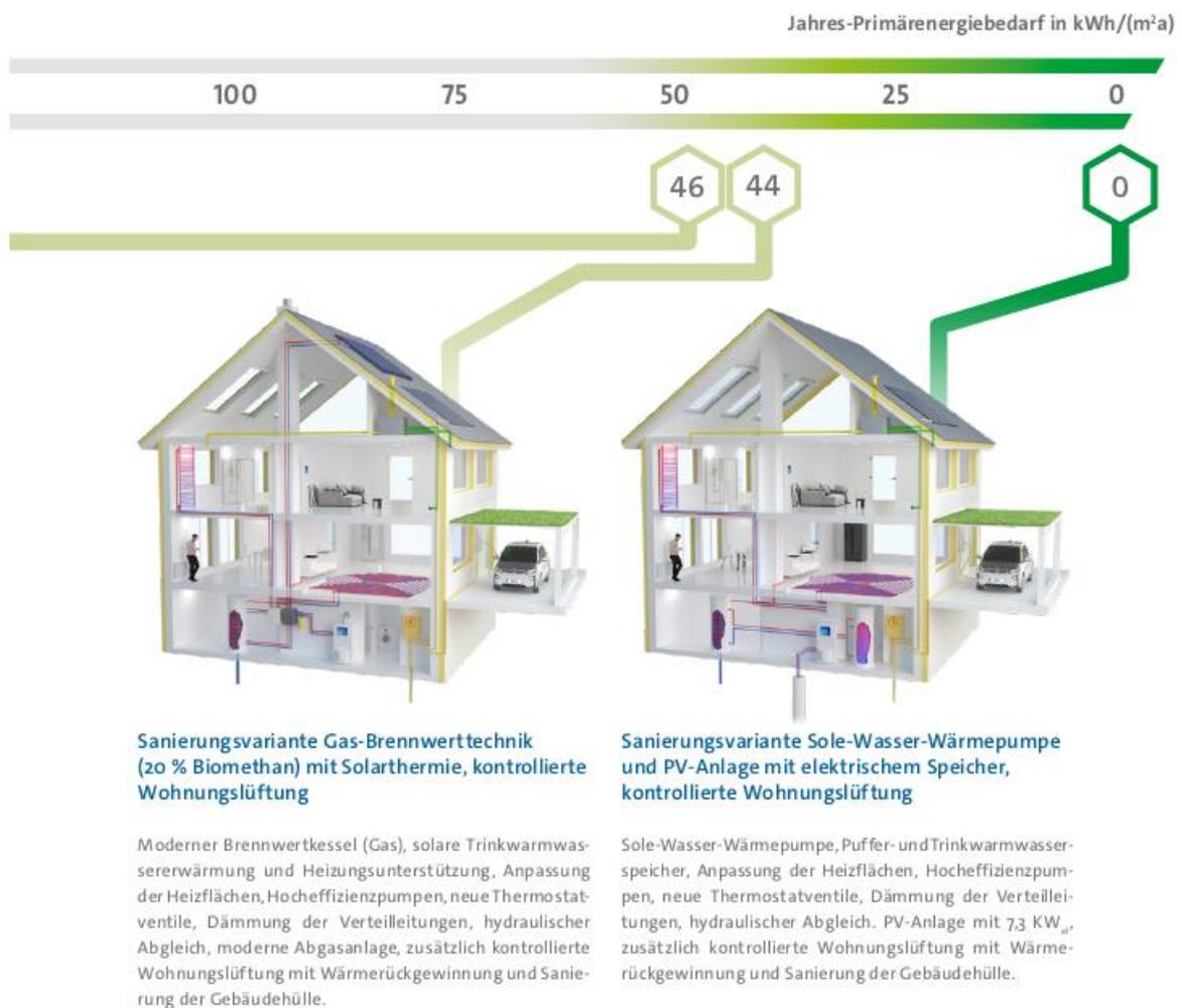
**Abbildung 21 Einsparpotenziale durch Kombination effizienter Anlagentechnik und energetischer Sanierung der Gebäudehülle**
